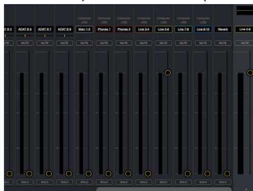
Cada mezcla tiene las entradas que se muestran aquí, con algunas variaciones según la mezcla. Para escuchar la entrada en la mezcla, simplemente suba su fader.
