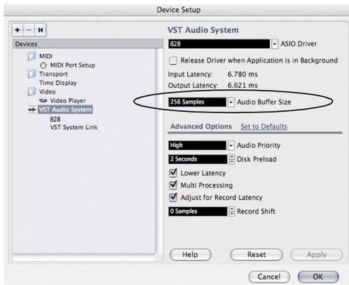
Figura 7-3. En Cubase o Nuendo, elija el menú Dispositivos > Configuración del dispositivo. Seleccione su interfaz (828), y luego haga clic en el botón Panel de Control para acceder a la ventana de arriba y a la configuración del Tamaño de Buffer.
